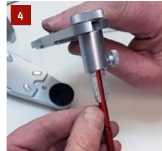
Replace the existing silver Candulor® anterior guide pin and fix the new red pin.
