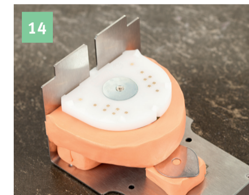
Fertig bepinte DIVARIO® Sockelplatte zur Kontrolle in den Abdruck setzen.
