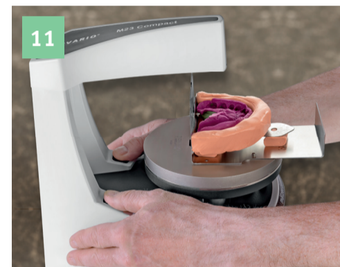
Bohrvorgang durch Knopfdruck starten, die DIVARIO® Plattenaufnahme Duo wird elektromagnetisch fixiert.
