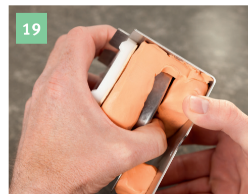
Nach ca. 25 Minuten vorsichtig die Abformung inklusive DIVARIO® Sockelplatte entnehmen.
