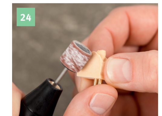
Einzelne Segmente mit einem DIVARIO® Schleifband bearbeiten und von Gipsstaub befreien.
