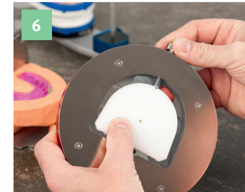
DIVARIO® Sockelplatte in die DIVARIO® Plattenaufnahme Duo des DIVARIO® Pinbohrgerätes M23 compact einspannen.
