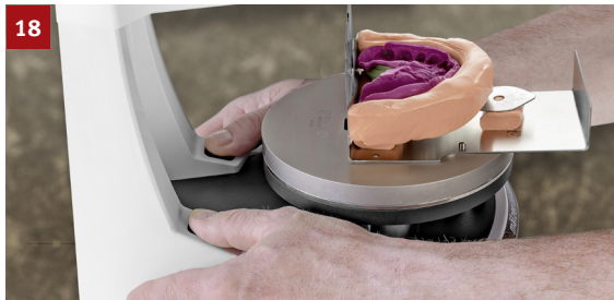
18 Bohrvorgang durch Knopfdruck starten – die DIVARIO® Plattenaufnahme Duo wird elektromagnetisch fixiert.
