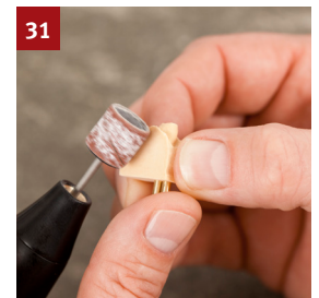
31 Einzelne Segmente mit einem DIVARIO® Schleifband bearbeiten und von Gipsstaub befreien.
